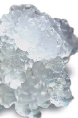
La nanocelulosa o microcelulosa es un material compuesto de fibrillas de celulosa de tamaño nanométrico normalmente obtenidas a partir de madera (fibras de pasta). Las propiedades de la microcelulosa constituyen un material interesante para diversas aplicaciones como capas barrera en los embalajes, aditivos en los estucados de papel, en productos de higiene/absorbentes y en una gran variedad de distintas aplicaciones. Fuente: Innventia.
