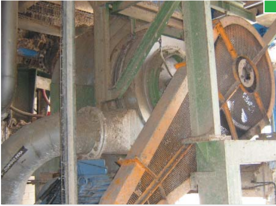
▲ Resguardo fijo en transmisión de correas. Se debe crear una envolvente en torno a la zona peligrosa, de forma que sea inaccesible
