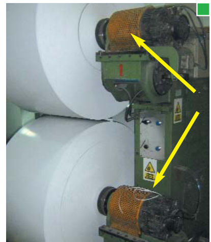
▲ Resguardos fijos para protección de los elementos móviles de transmisión
