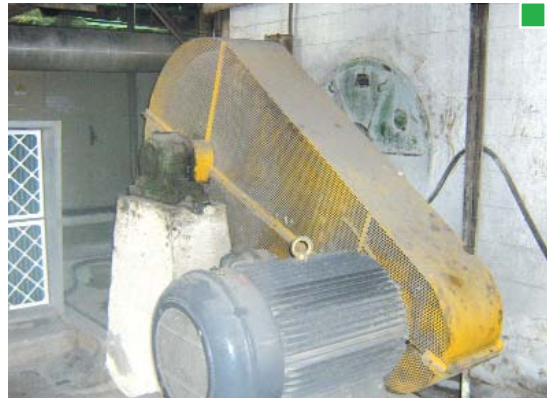
▲ Resguardo fijo de transmisión por correas
