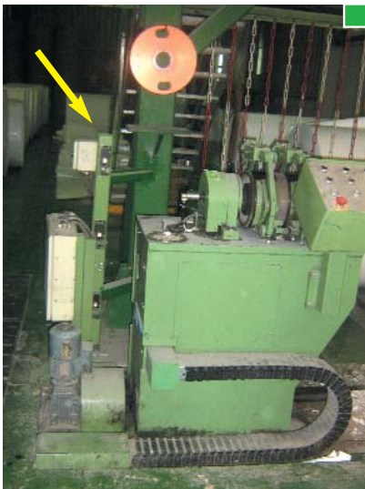
▲ Poste con tres células fotoeléctricas para detectar el acceso de personas
