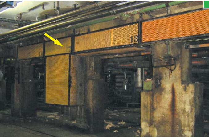
▲ Envoltente que protege el recorrido de la cuerda
