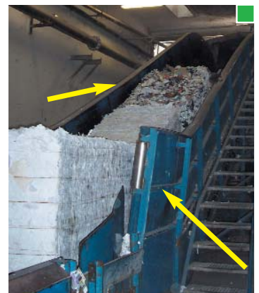
▲ Ejemplos de protección lateral que retienen las balas o bobinas en caso de vuelco ▲
