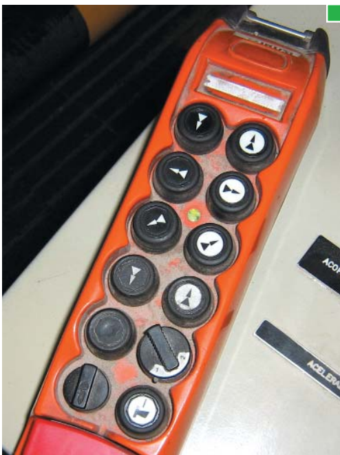
▲ Identificación de funciones mediante flechas
