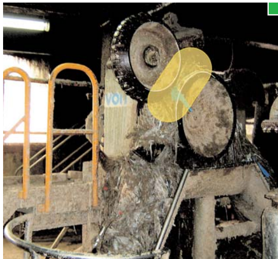
▲ Protección por ambos lados entre las dos ruedas dentadas
