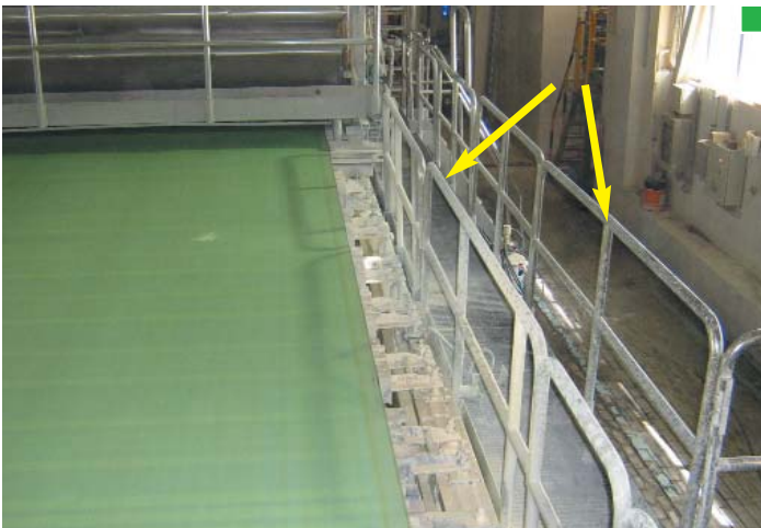
▲ Ejemplo de barandilla que protege del riesgo de caída a la tela
