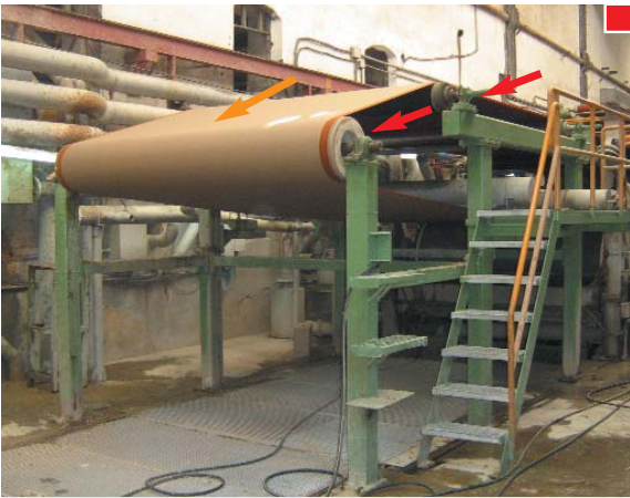
▲ Deben protegerse, mediante resguardos fijos, los nips fieltro-rodillo que sean accesibles ▲
