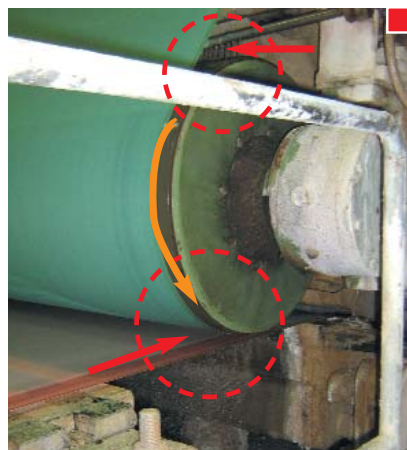
▲ Vista lateral de la zona de atrapamiento (accesible) a proteger
