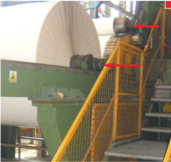
▲ La zona de riesgo no debe ser accesible tampoco desde los medios de acceso
