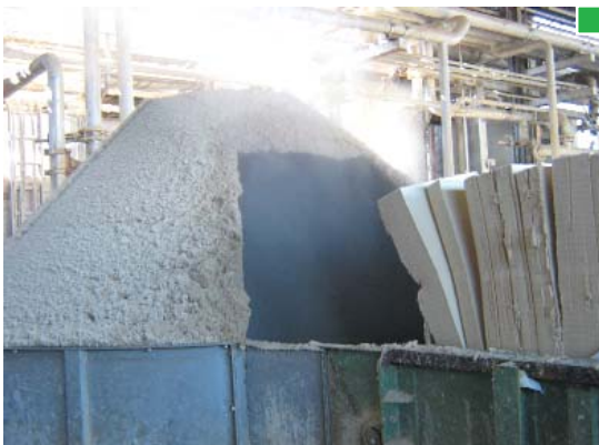
▲ Ejemplo de cerramiento superior en un púlper. Únicamente tiene una apertura para la entrada de materia prima ▲
