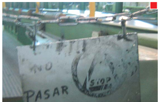
▲ Las cadenas no son medios de protección adecuados contra los riesgos de caída de personas.
