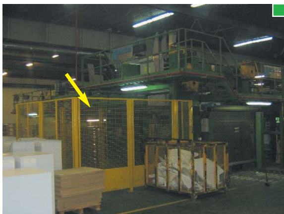
▲ Perímetro en torno al apilador (zona inferior) protegido mediante resguardo fijo ▲
