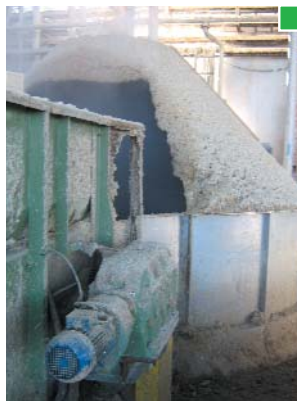
▲ Ejemplo de cerramiento superior en un púlper. Únicamente tiene una apertura para la entrada de materia prima ▲
