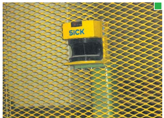
▲ Zona inferior de un elevador de palets en una cortadora. En el caso de entrar una persona en la zona peligrosa el equipo para por estar la zona protegida por un roto-escáner (vista del dispositivo, fotografía derecha).
