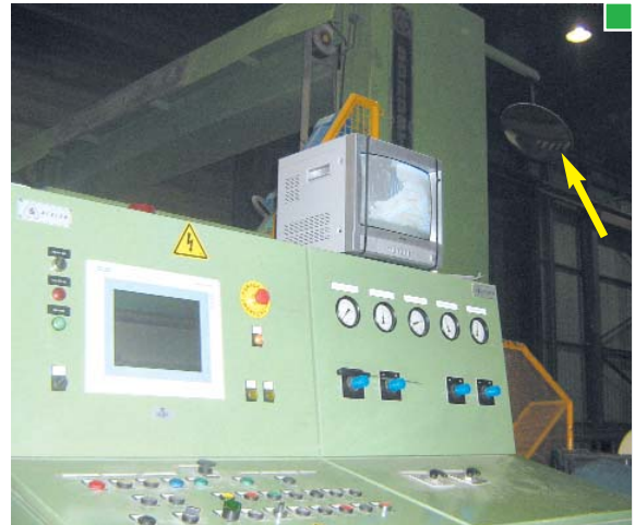
▲ La instalación de espejos y/o cámaras es una posible solución para solventar el problema de la falta de control visual desde el pupitre de control
