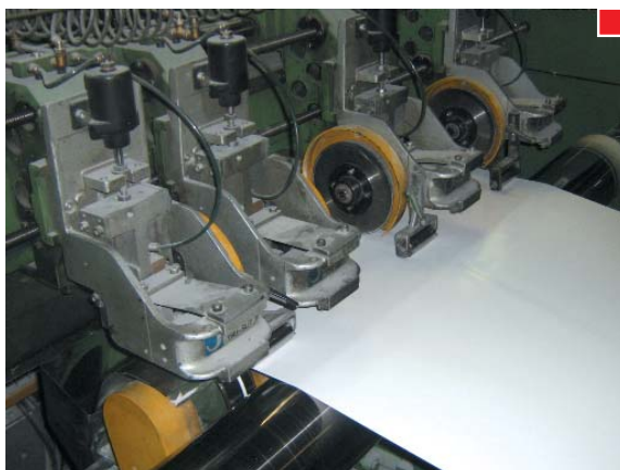
▲ La distancia entre la protección y el filo de la cuchilla no debe ser mayor de 6 mm.
