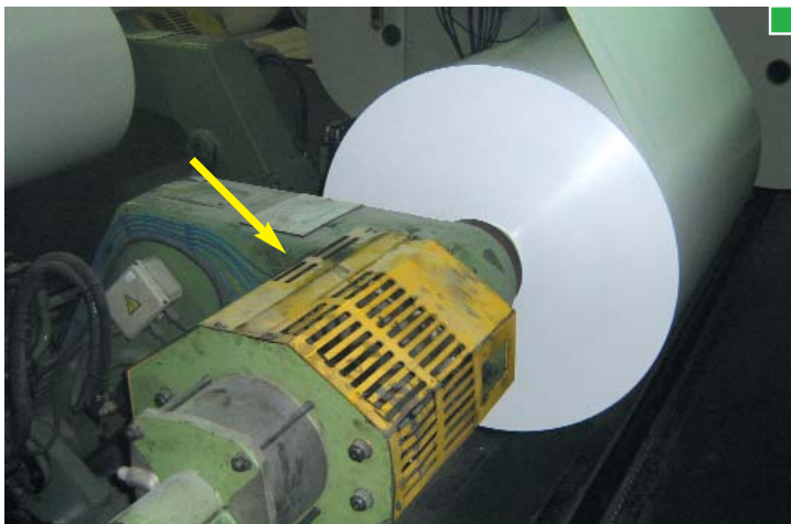
▲ Resguardos fijos para protección de los elementos móviles de transmisión
