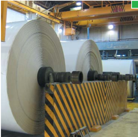
▲ Almacenamiento correcto cuando los rollos se transportan con grúa, teniendo el operario control visual de la zona
