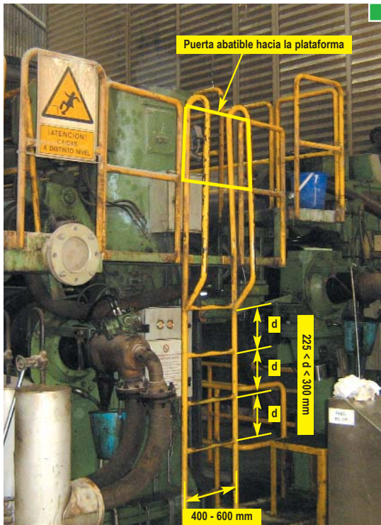
▲ Escala vertical según UNE EN ISO 14122-4
