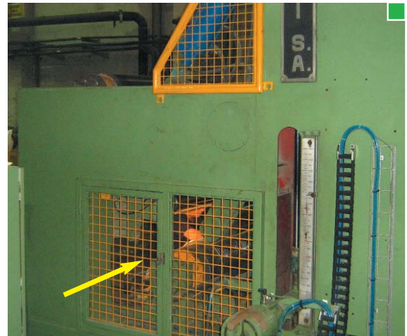
▲ Ejemplo de protección mediante resguardo tipo rejilla
