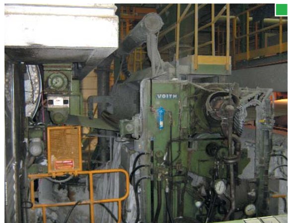
▲ Protección del hueco con barandilla fija. Incluye rejilla para evitar acceso a elementos móviles (ver pág. 74)
