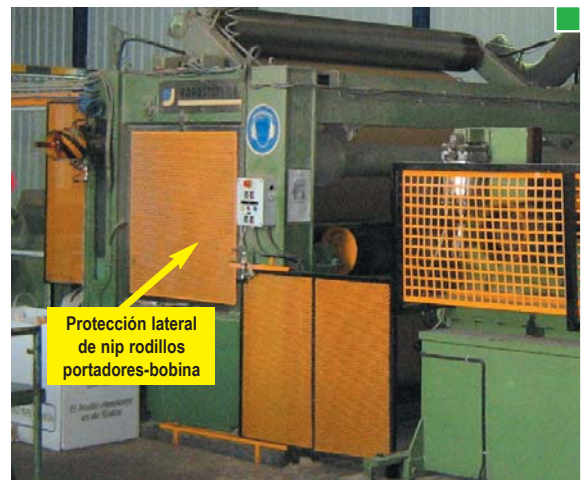
▲ Los accesos a las zonas de riesgo deben estar cerrados cuando la velocidad es superior a la de embarque de la hoja (10 m/min. según la norma UNE-EN 1034-3)
