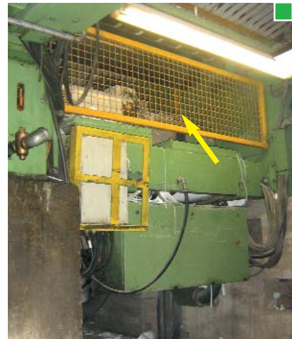
▲ Protección de la cuchilla transversal, en la parte inferior, mediante resguardo fijo tipo rejilla
