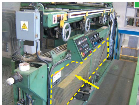
▲ La protección debe ser un resguardo fijo
