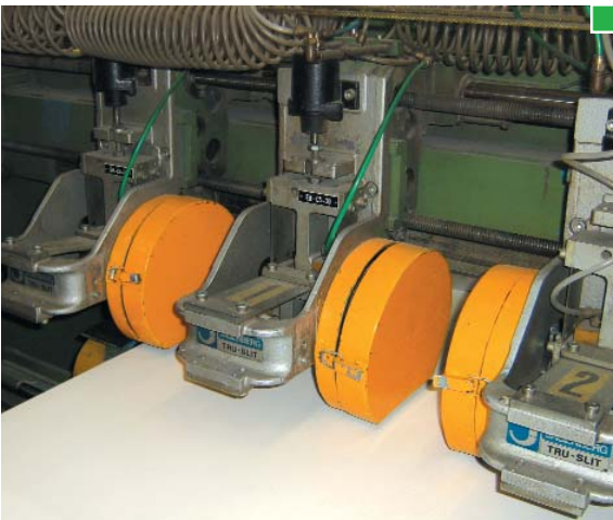
▲ Cuchilla totalmente cerrada mediante envoltente.
