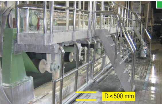
▲ Ejemplo de protección de la zona inferior de la mesa respecto al peligro de caídas al foso o tela. ▲ En este caso, el guardacuerpos, cuelga de la pasarela superior
