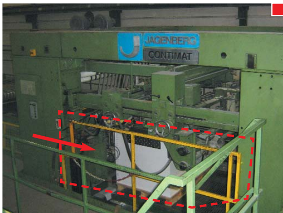
▲ La barandilla no es adecuada como protección contra atrapamientos entre partes móviles y fijas
