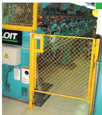
▲ Resguardo móvil asociado a dispositivo de enclavamiento
