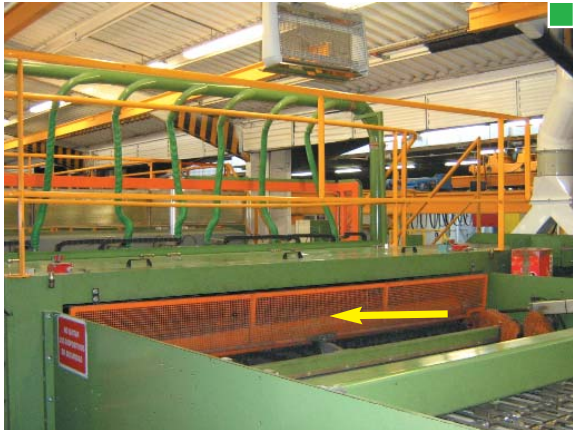
▲ Resguardo fijo a la salida de la cuchilla transversal
