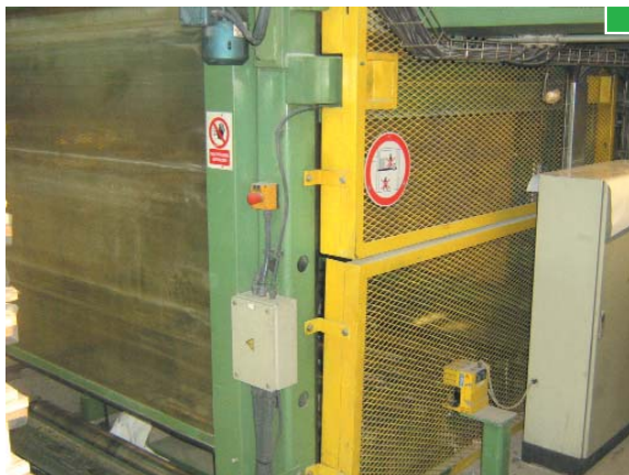
▲ El roto-escáner realiza un barrido láser del área asignada y para el equipo de trabajo al detectar un obstáculo ▲
