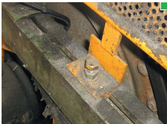
▲ La fijación debe estar garantizada por sistemas de apertura que necesiten utilizar herramientas
