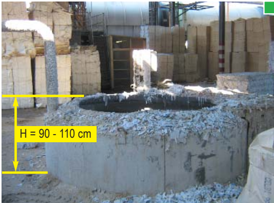
▲ Vista de un púlper con protección en su perímetro
