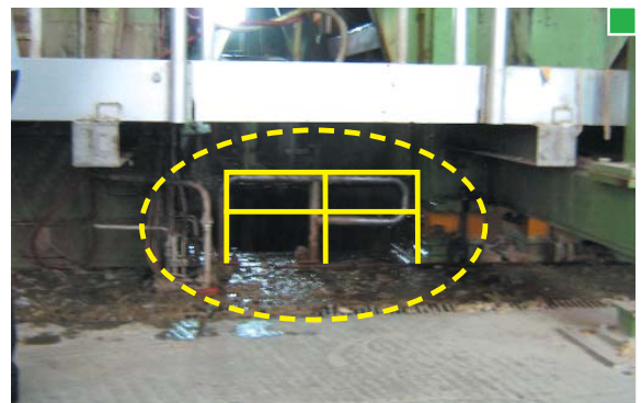
▲ El hueco debe protegerse con barra intermedia o guardacuerpos como el ejemplo de la fotografía si el espacio libre es mayor de 500 mm
