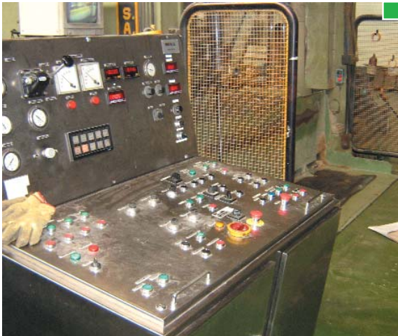
▲ Cuadro de mandos ubicado de forma que se tiene control visual de la zona de salida de bobinas. Ejemplo también de protecciones laterales
