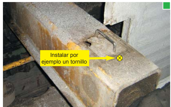
▲ Para la apertura de la tapa, igual que para el resguardo, debe ser necesaria una herramienta
