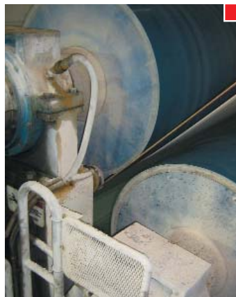
▲ El nip entre los dos rodillos debe protegerse por el lado conductor y accionamiento, si es accesible
