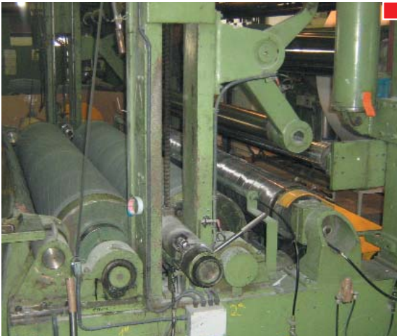
▲ El dispositivo de descenso y elevación del rodillo de presión, así como los portamandriles, deben ser inaccesibles por ambos laterales
