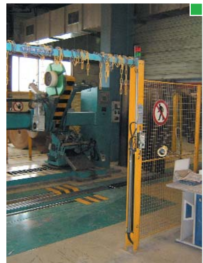
▲ Perímetro cerrado que evita el acceso a elementos móviles con dispositivo sensible (barrera fotoeléctrica) en la zona abierta del perímetro ▲
