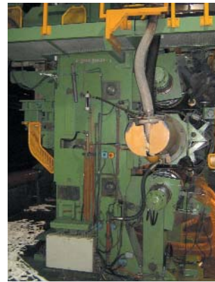
▲ Zona de paso habitual entre batería de secadores y lisa. Las zonas de atrapamiento que son accesibles desde zonas de paso transversales a la máquina de papel, deben protegerse a todo lo ancho.
