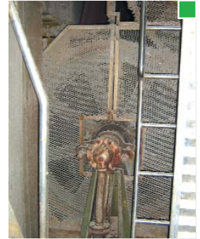
▲ Ejemplo de resguardo de ruedas dentadas
