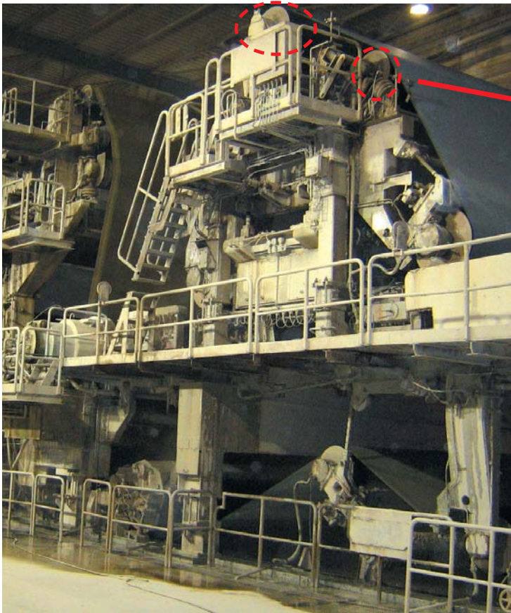
▲ Los formadores superiores disponen de pasarelas que permiten acceder a los nips tela-rodillo
