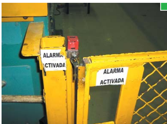
▲ Detalle del dispositivo enclavamiento, del tipo base-clavija
