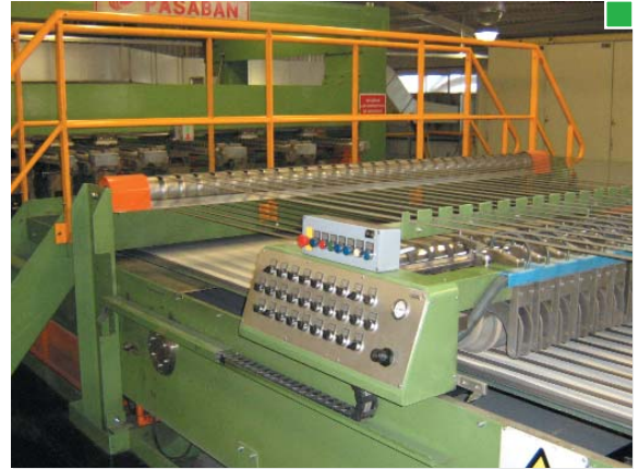
▲ Pasarela transversal que dispone de barandilla por ambos lados
