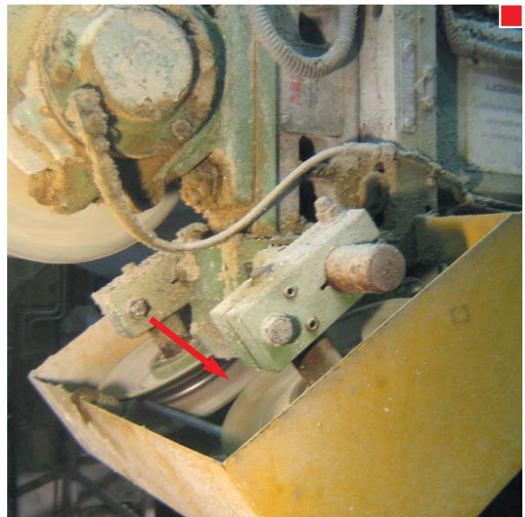
▲ La protección debe crear una envolvente que impida acceder a la zona peligrosa
