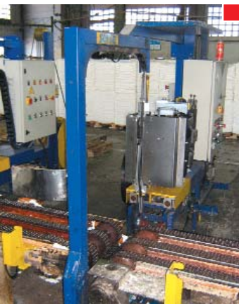
▲ Alambradora sin protección
