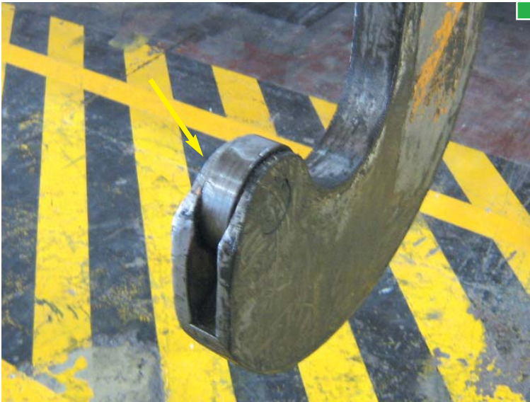
▲ Otra medida alternativa es la instalación de un rodamiento en el extremo del gancho que rota evitando el desenganche del rollo ▲
