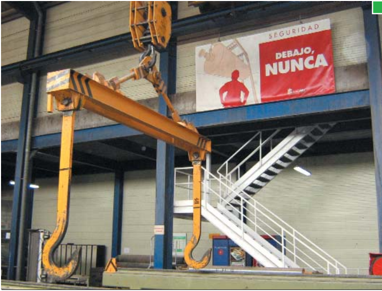
◀ ▲ Un gancho con mayor altura respecto al eje del mandril es una medida alternativa
