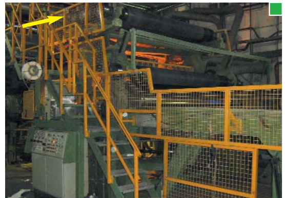
▲ La zona peligrosa no debe ser accesible tampoco desde los medios de acceso
