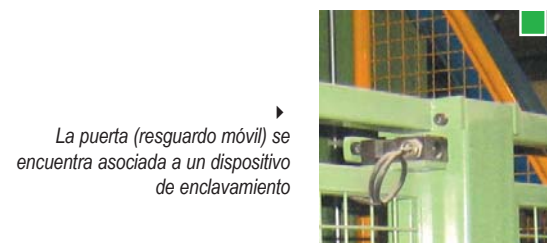
▲ Protección perimétrica para proteger de varios elementos móviles de transmisión en la misma zona
