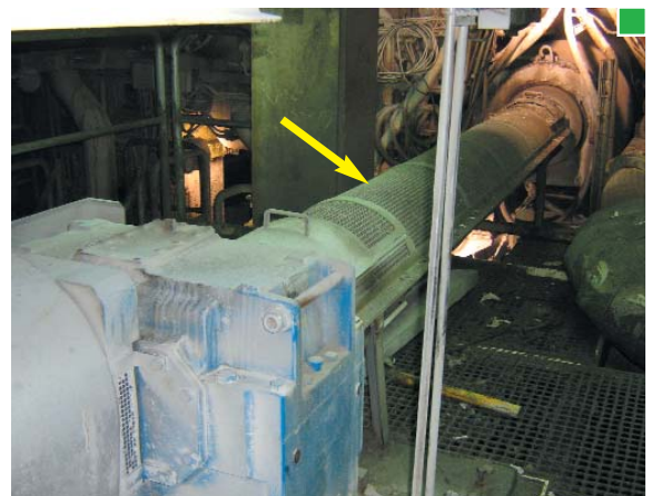
▲ Vista de protecciones mediante resguardos fijos de transmisiones entre motores y rodillos (cardans) en el lado transmisión ▲
