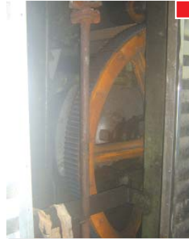
▲ Las puertas correderas no son resguardos para los engranes
