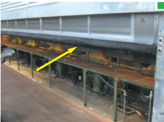
▲ Borde de dispositivo sensible de detección mecánica. Para evitar peligros de aplastamiento en el descenso de la puerta
