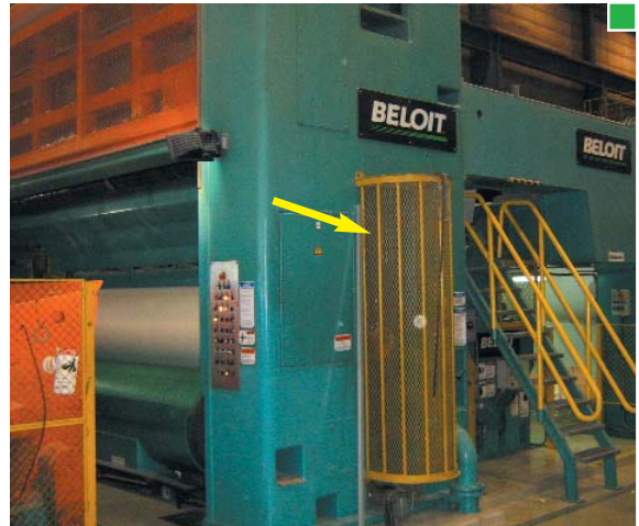
▲ Ejemplo de protección lateral de zonas de atrapamiento entre partes fijas y móviles
