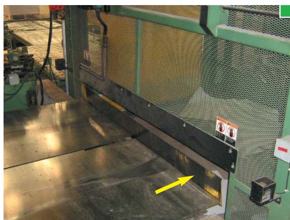
▲ Acceso cerrado y hueco para entrada de palets protegido con pletina abatible
