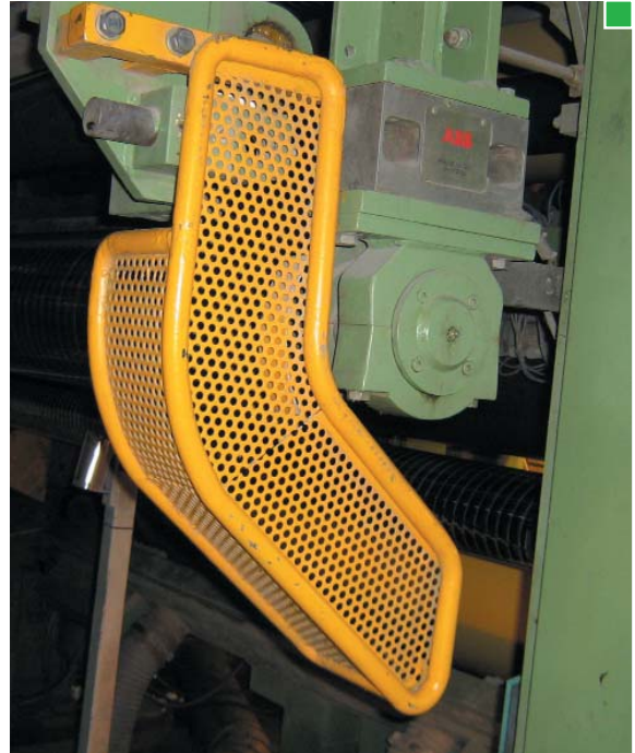
▲ Ejemplo de protección en nip cuerda-polea. La protección debe crear una envolvente que impida acceder a la zona peligrosa
