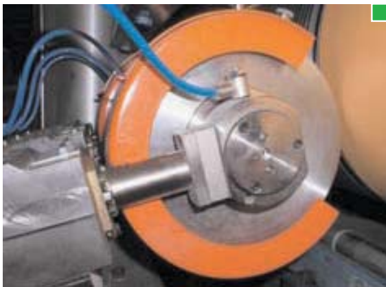
▲ Otra forma de protección de la cuchilla
