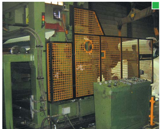
▲ Ejemplo de protección lateral, que además protege del riesgo de atrapamiento entre el brazo primario y el mandril
