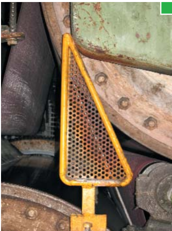
▲ Resguardo fijo de nip cuerda-secador
