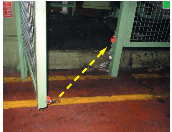
▲ Ejemplo de puerta de acceso asociada a dispositivo de enclavamiento
