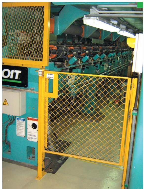
▲ Acceso al pasillo de la sección de cuchillas cerrado con puerta asociada a dispositivo de enclavamiento.
