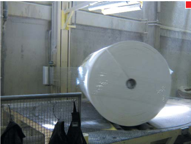
▲ Plataforma giratoria en embaladora para papel tisú, sin protección
