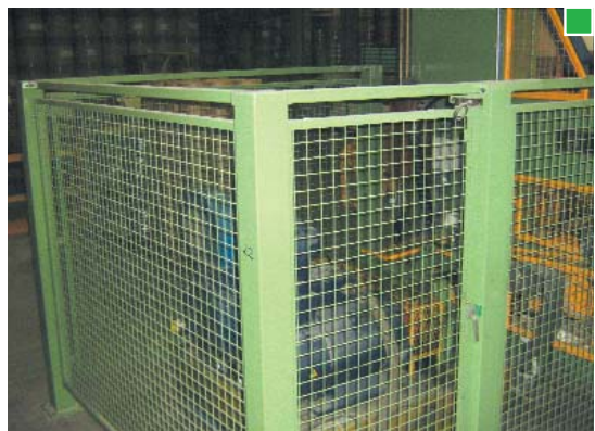
▲ Protección perimétrica para proteger de varios elementos móviles de transmisión en la misma zona
