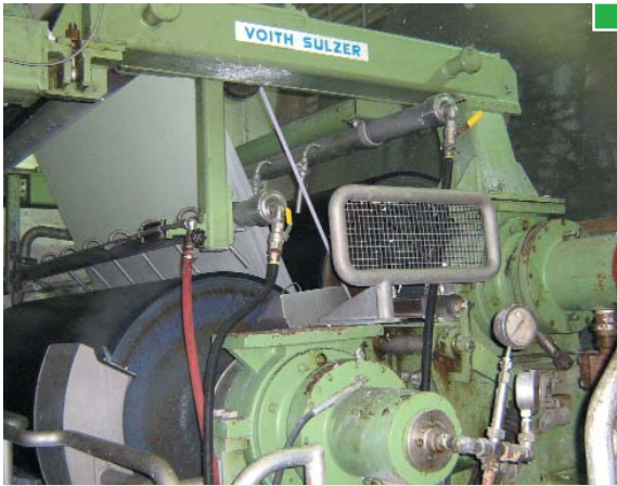
▲ Ejemplo de resguardo fijo en nip de rodillos de la prensa
