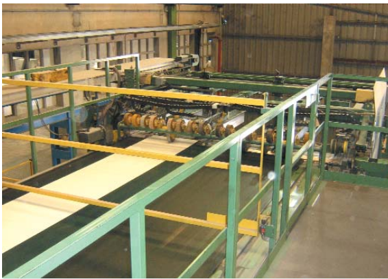
▲ Cinta transportadora a la entrada al apilador (al fondo)
