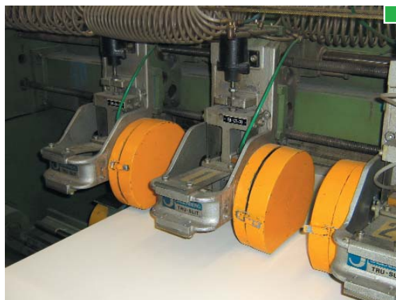
▲ Cuchilla totalmente cerrada mediante envolvente
