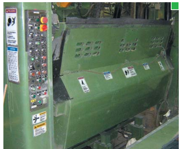
▲ Con la máquina en marcha, los dispositivos de bajada de bobinas (cunas) evitan el acceso al nip rodillo portador-bobina
