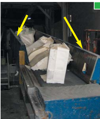
▲ Ejemplos de protección lateral que retienen las balas o bobinas en caso de vuelco ▲
