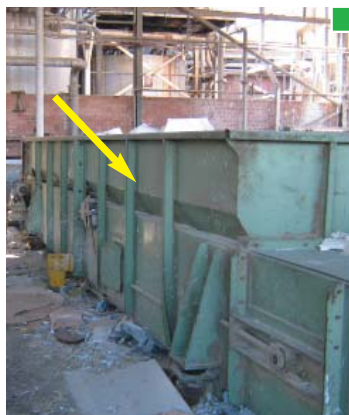
▲ Ejemplos de protección lateral que retienen las balas o bobinas en caso de vuelco ▲
