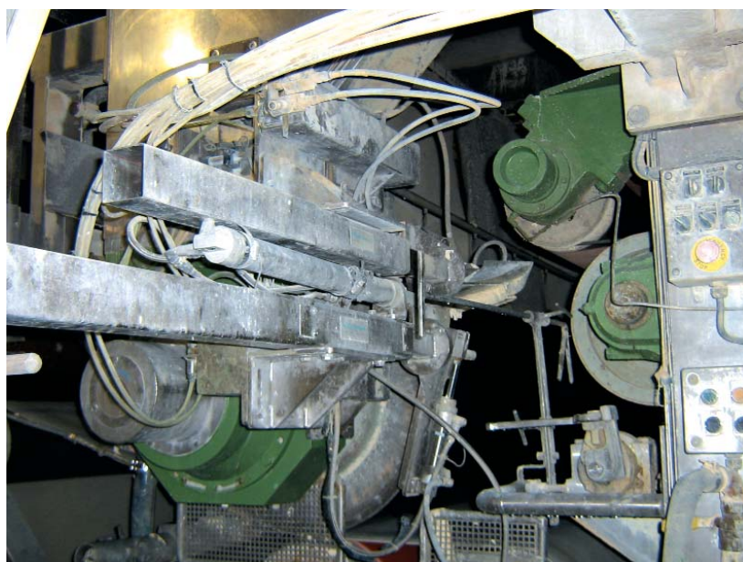
▲ Dispositivo automático para paso de hoja de prensas a rodillo embarcador de sequería. El dispositivo corta y despegla la tira, que viene de abajo hacia arriba adherida a la prensa, lanzándola mediante aire hacia el nip manta-rodillo embarcador.
