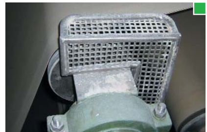
▲ Ejemplo de resguardo fijo que impide el atrapamiento
