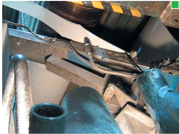
▲ Vista de la banda con aspiración interna en posición para paso de hoja. Giro de 90° respecto a posición de reposo.
