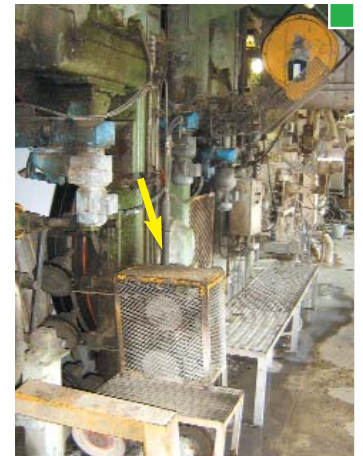
▲ Ejemplo de resguardo fijo en nip cuerda-polea
