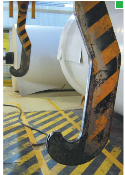
▲ Otra medida alternativa es la instalación de un rodamiento en el extremo del gancho que rota evitando el desenganche del rollo ▲
