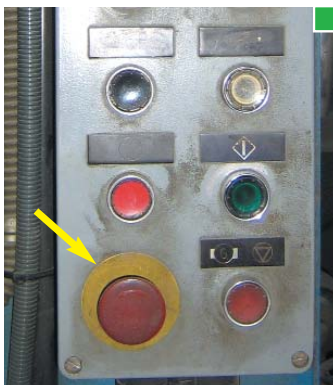
◀ Según las normas EN 418 y EN 60204-1 las paradas de emergencia será de color rojo y si es posible sobre fondo amarillo.
