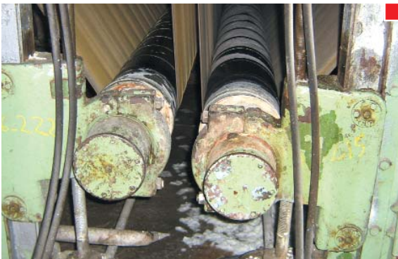
▲ Zona de prensas en el sótano, deben protegerse los nips
