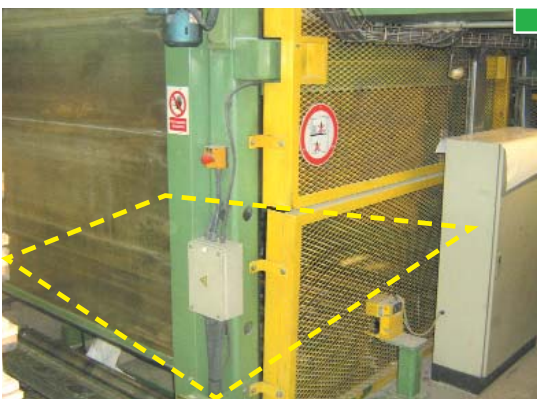
▲ Zona inferior de un elevador de palets en una cortadora. En el caso de entrar una persona en la zona peligrosa el equipo para por estar la zona protegida por un roto-escáner (vista del dispositivo, fotografía derecha).
