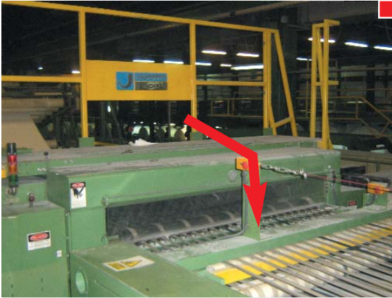
▲ Pasarela transversal que no dispone de protección en un lado
