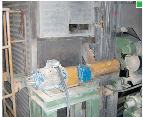
▲ Ejemplo de transmisiones cardan y acoplamientos protegidos mediante resguardos fijos
