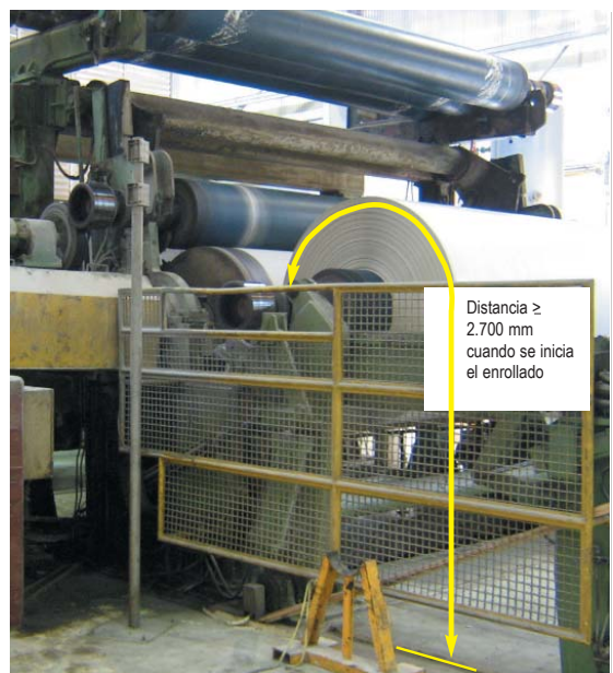
▲ Debe impedirse también el acceso a la línea de contacto desde la zona frontal. Una solución es instalar protecciones adecuadas y otra, cuando esto no sea factible, aumentar la distancia mínima (2700 mm) elevando la enrolladora o bajando el nivel del suelo. (ver pág. 158)
