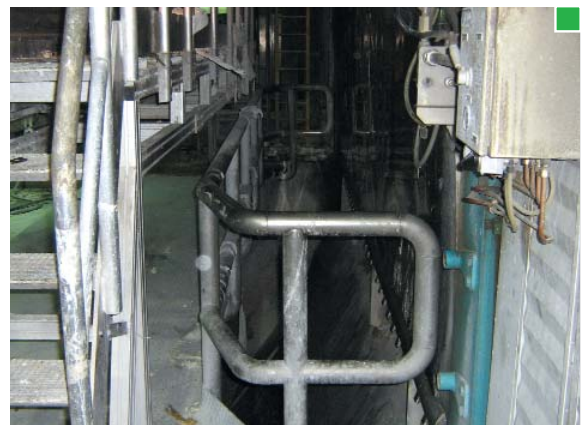
▲ Si el riesgo de caída existe a todo lo ancho de la máquina debe protegerse todo su perímetro con barandilla
