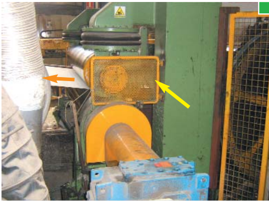
▲ Protección de nip de rodillos de lisa
