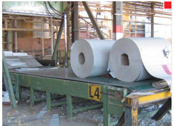
▲ En el caso de bobinas, la estabilidad depende del ancho de las mismas
