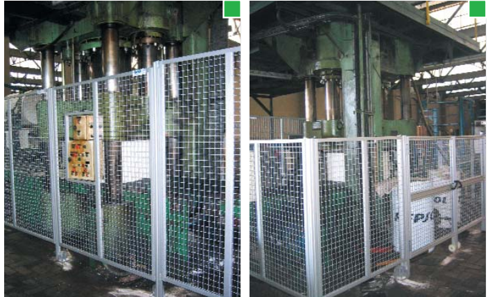
▲ Protección perimetral de prensa ▲ con puertas de acceso asociadas a dispositivo de enclavamiento
