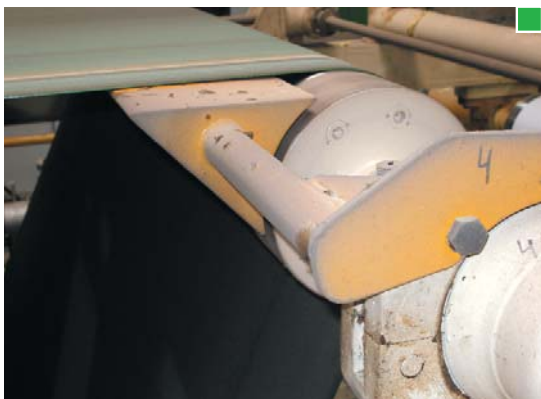
▲ Diferentes tipos de resguardos fijos en línea de contacto tela-rodillo ▲
