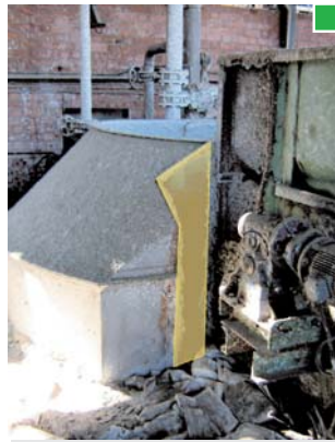
◀ ◻ Ejemplos de protección en huecos con posible acceso entre cierre perimetral y cinta de alimentación
