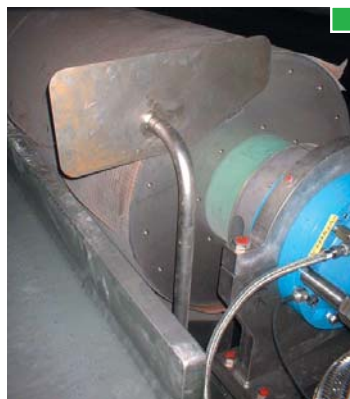
▲ Diferentes tipos de resguardos fijos en línea de contacto tela-rodillo ▲
