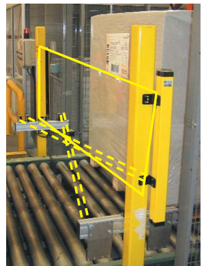
▲ Combinación de fotocélulas y barrera fotoeléctrica formando el sistema muting.
