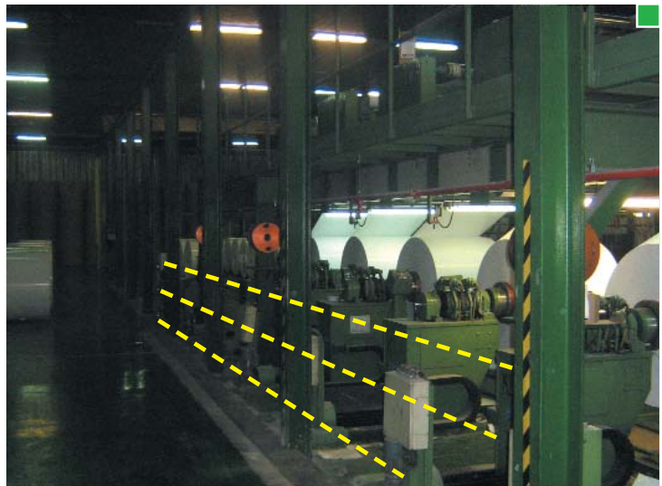
▲ Poste con tres células fotoeléctricas para detectar el acceso de personas
