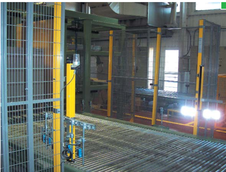
▲ Sistema muting instalado en la entrada y salida consistente en dispositivo sensible que combina barrera fotoeléctrica y juegos de fotocélulas, ▲ de forma que distingue el paso de una persona del paso de la carga embalada. Ver el anexo Resguardos en donde se detalla este dispositivo
