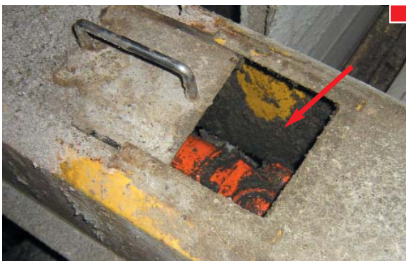
▲ Tapa sin fijar y sin señalar, para engrase de cardan
