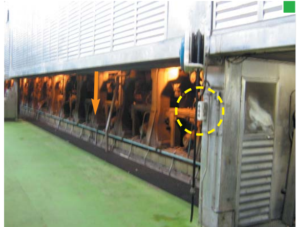
▲ Los mandos de accionamiento se deben ubicar donde se tenga un control visual de la zona de riesgo
