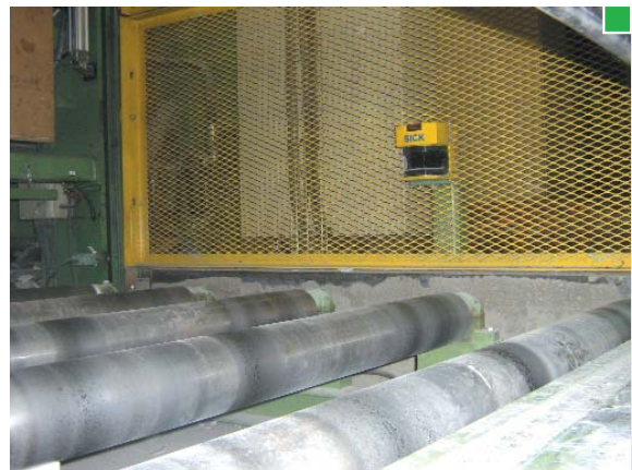
▲ El roto-escáner realiza un barrido láser del área asignada y para el equipo de trabajo al detectar un obstáculo ▲
