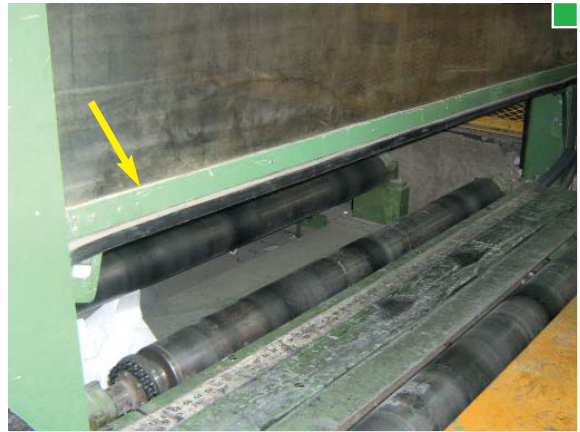
▲ Dispone de borde sensible para evitar atrapamientos en su descenso
