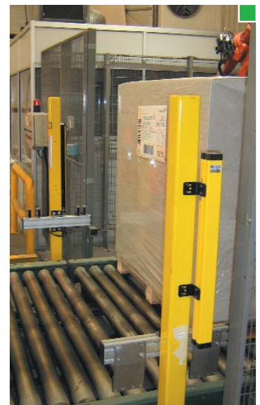
▲ Sistema muting instalado en la entrada y salida consistente en dispositivo sensible que combina barrera fotoeléctrica y juegos de fotocélulas, ▲ de forma que distingue el paso de una persona del paso de la carga embalada. Ver el anexo Resguardos en donde se detalla este dispositivo
