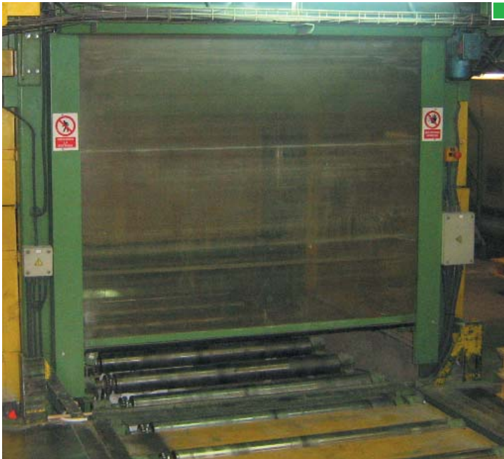
▲ Detalle de cortinas que se elevan únicamente para permitir el paso del producto, impidiendo el acceso a la zona, durante el resto del tiempo. ▲ A fin de evitar el riesgo de golpes en su descenso, debe llevar incorporado un borde sensible
