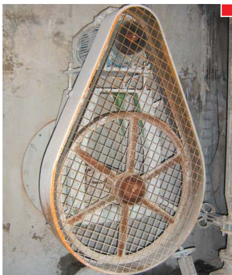
▲ Resguardo tipo rejilla 50 x 50 mm a una distancia de 80 mm del elemento móvil. Para dicha distancia la rejilla debería ser como máximo de 12 x 12 mm.
