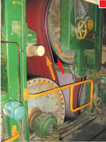
▲ Nip manta-secador sin protección
