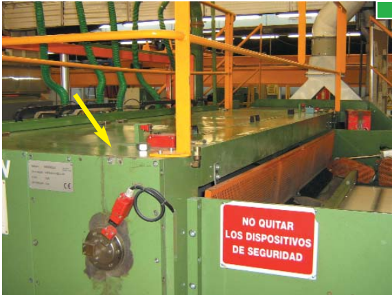
▲ Dispositivos de enclavamiento asociados a los resguardos que protegen la cuchilla transversal
