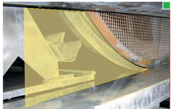
▲ Ejemplo de resguardo fijo que impide el acceso
