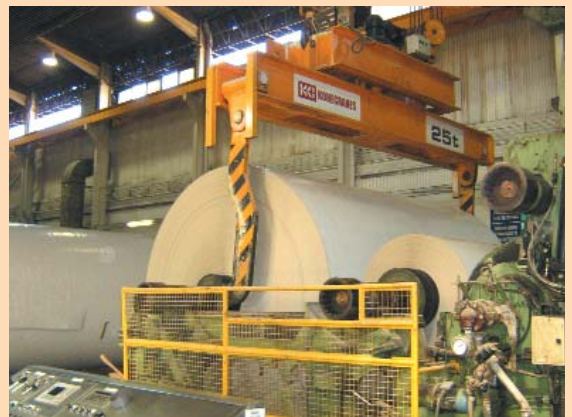
▲ Retirada de bobina mediante puente grúa
