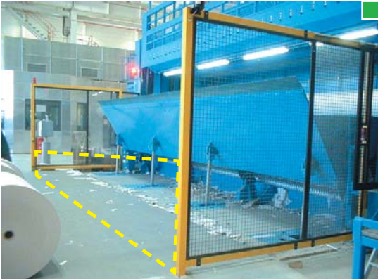
▲ Barrera fotoeléctrica en la zona de salida de bobinas de una bobinadora.
