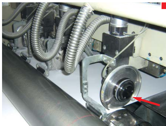
▲ Cuchillas circulares, debe protegerse la zona de corte de forma que sea inaccesible ▲
