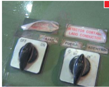
▲ Es desaconsejable el uso de pegatinas por no soportar las condiciones del entorno
