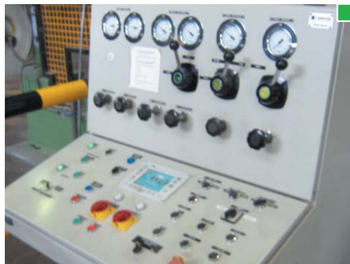
◀ Según las normas EN 418 y EN 60204-1 las paradas de emergencia será de color rojo y si es posible sobre fondo amarillo.
