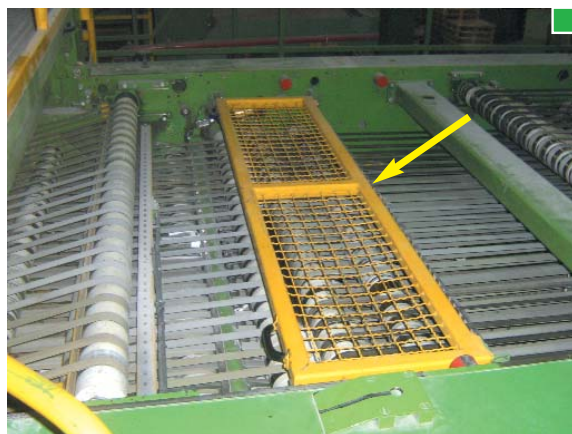
▲ Resguardo fijo a todo lo ancho de la máquina
