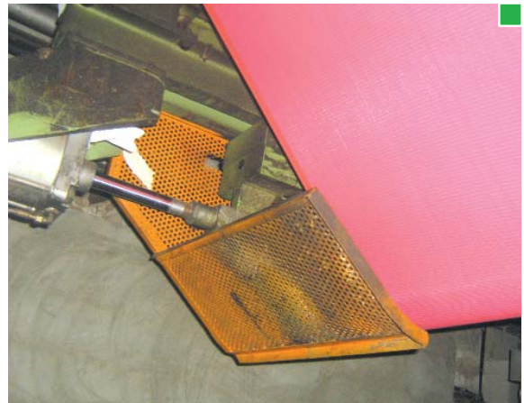
▲ Otros ejemplos de resguardos fijos ▲
