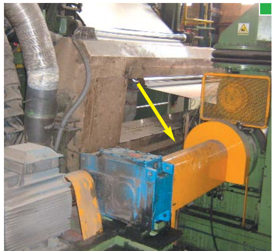
▲ Resguardos fijos en transmisiones. Ver además como está protegido el acoplamiento y la línea de contacto de los rodillos de la lisa
