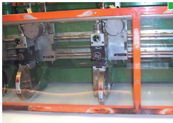
▲ Pantalla móvil que impide el acceso a la zona de corte. ▲
