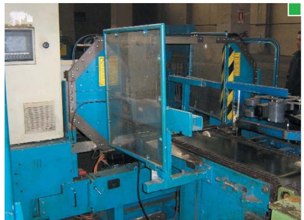
▲ Alambradora protegida mediante resguardo fijo
