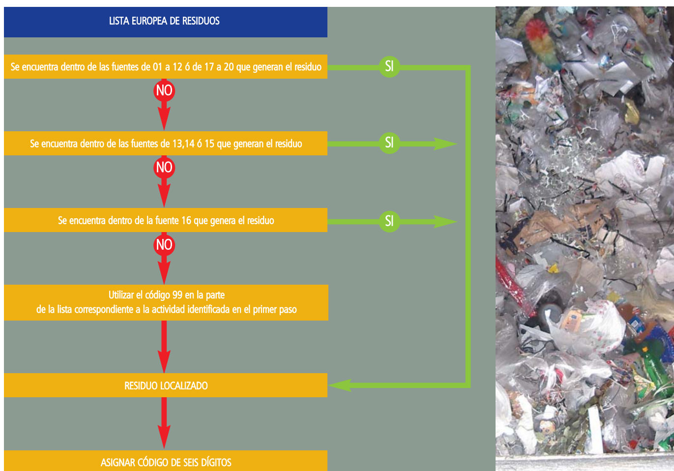
Figura 4.4. Diagrama para la identificación de un residuo según la Lista Europea de Residuos.
