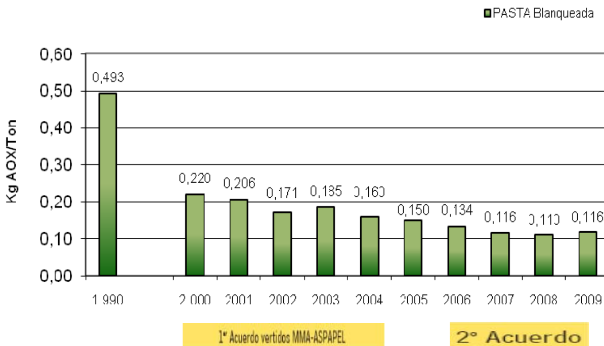
Figura 11. Variación de la carga unitaria del vertido de AOX (sólo para pasta blanqueada) en Kg/Tm producida de pasta o papel de 1990 a 2009.
